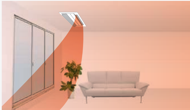
Após dirigir a temperatura definida, o ar quente é periodicamente direcionado para as janelas. Isso cria uma barreira que impede a circulação de ar frio.
